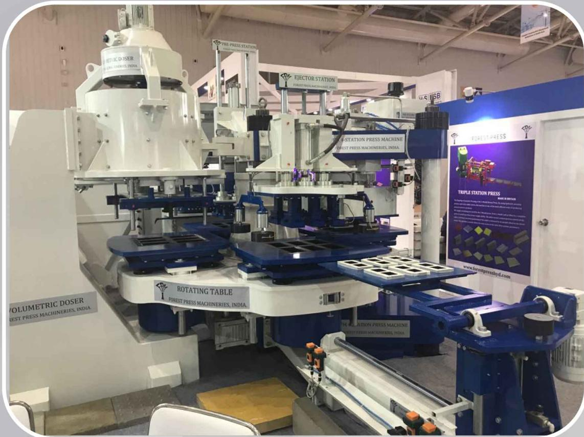
پرس با میز گردان ۴ ایستگاه کار میکند که هر ایستگاه در محور دورانی ۹۰ درجه قرار دارد و با اجزاء پرس، مکش آب و سیستم خلاء مجهز شده است. قطعات بتنی ۱۵ تا ۱۰۰ میلیمتر قادر به تولید با این دستگاه هستند. این دستگاه طراحی شده تا با انواع قالبها تولید کند و شامل قطعات مجزا و ادوات به همراه پرس است. سازه فلزی شامل فریم اصلی است که بعد از ساخت مراحل ماشین کاری ، تنش زدایی، تست و مونتاژ را پشت سر گذاشته تا بتواند بهترین قطعات بتنی را تولید کند.
