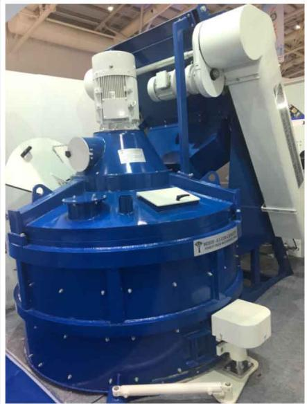
میکسرهای طراحی شده توسط فارست پرس سری مگا استار، بهترین راه حل برای مخلوط بتن همگن است. میکسرهای پلنتری با طراحی بهینه و ویژگیهای ایمنی داخلی، معادل با استانداردهای بین المللی می باشد. شدت میکس بالای آن ما را قادر میسازد که بتوان خروجیهای متفاوت از همان میکسر بگیریم.
